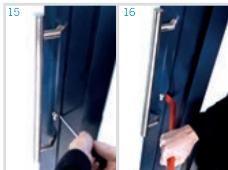
↑ 15 Poging inbraak met schroevendraaier aluminium deur. ↑ 16 Poging inbraak met breekijzer.
