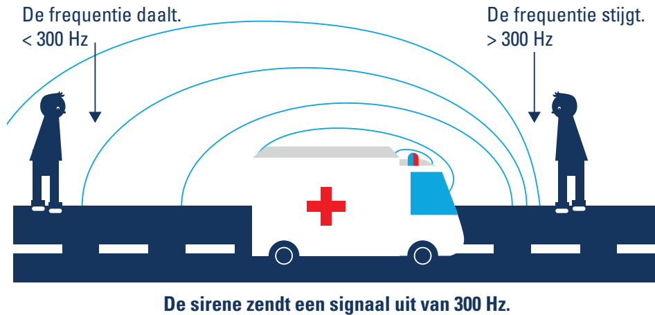
† 98 Schematische voorstelling van het dopplereffect.
