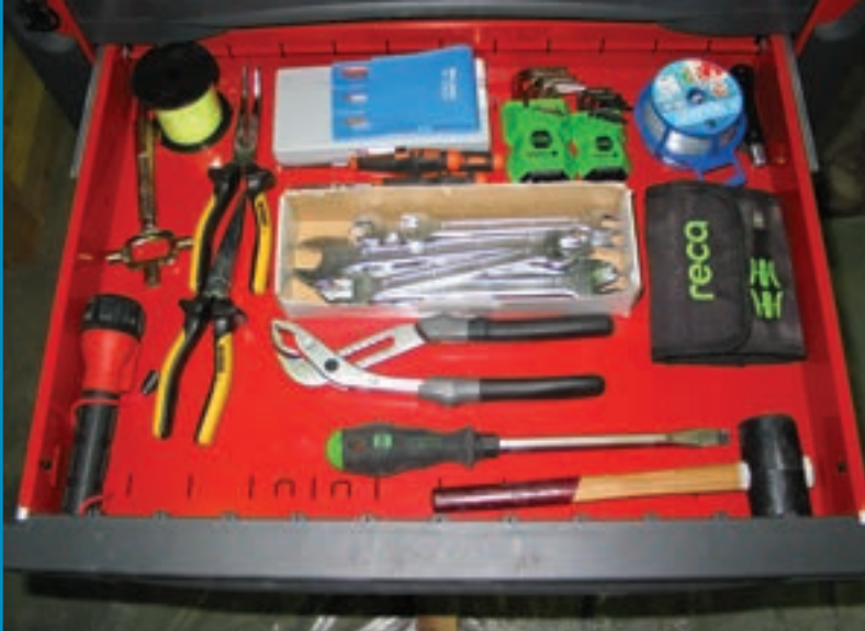
† 9 en 10: Gereedschapssets A1 en A2 voor de manuele proef op gevelelementen met inbraakweerstandsklasse 2.
