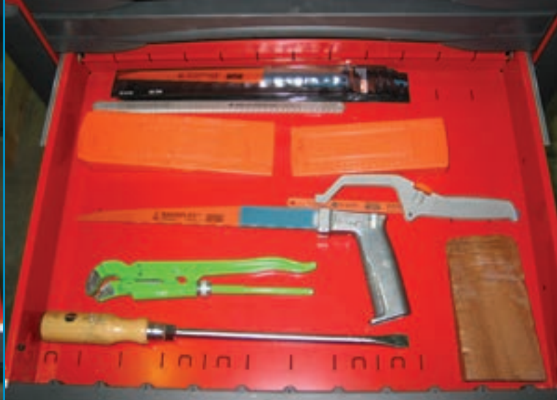
† 9 en 10: Gereedschapssets A1 en A2 voor de manuele proef op gevelelementen met inbraakweerstandsklasse 2.
